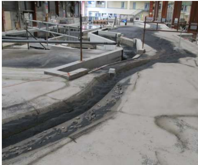
Նկ. 18. Ինգա ամբարտակի վերին բյեֆում նստվածքագոյացման գործընթացի մոդելավորումը Մասշտաբը՝ 1:140 (հոր.), 1:100 (ուղ.)
