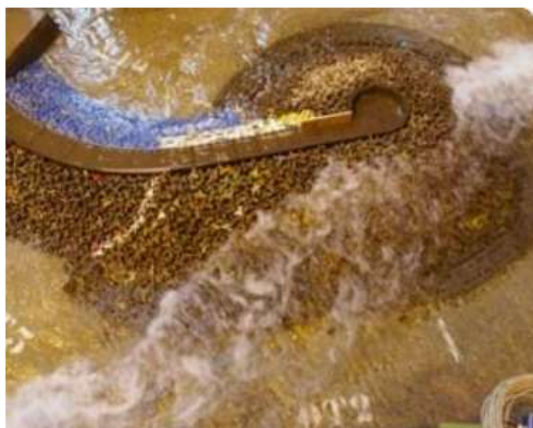
Նկ. 11 Հիդրոէլեկտրակայանի ջրընդունիչ հանգույցի (Մարոկկո) մոդելավորման օրինակ, Մ 1:68
