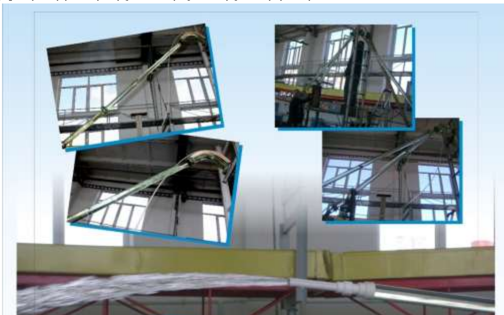
Նկ. 20 Ակադեմիկոս Ի.Վ. Եղիազարովի անվան ջրային հիմնահարցերի և հիդրոտեխնիկայի ինստիտուտի հիդրավլիկական հետազոտությունների լաբորատորիայում օդային կուտակումների հետազոտման փորձասարքը
