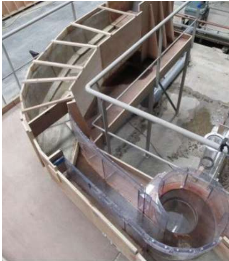
Նկ. 10 Հորանային ջրընդունիչ կառուցվածի մոդելի օրինակ, Մ:20
