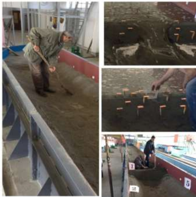
Նկ. 17 Ակադեմիկոս Ի.Վ. Եղիազարովի անվան ջրային հիմնահարցերի և հիդրոտեխնիկայի ինստիտուտի հիդրավիկական հետազոտությունների լաբորատորիայում հողային պատվարի փլուզման մոդելավորումը
