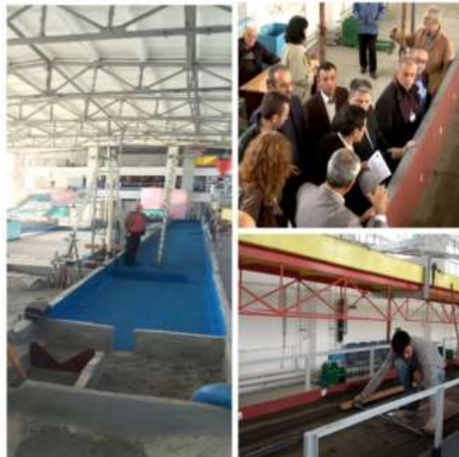
Նկ. 19 Ակադեմիկոս Ի.Վ. Եղիազարովի անվան ջրային հիմնահարցերի և հիդրոտեխնիկայի ինստիտուտի հիդրավլիկական հետազոտությունների լաբորատորիայում կուտակված գրունտների հիդրավլիկական լվացման մոդելային փորձարկումներ (Սևծովյան Եվրոպական ծրագրի շրջանակ՝ Հունաստան, Թուրքիա, Վրաստան, Հայաստան)
