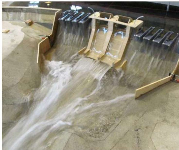
Նկ. 14. «Հիդրոպլուս» համակարգի դիմհարի փորձարկում Շարմինի ջրամբարի (Ֆրանսիա) բետոնային պատվարի մոդելի վրա
