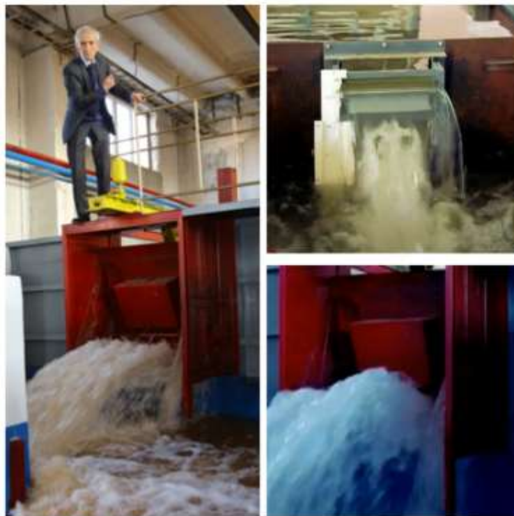
Նկ. 15 Ստացիոնար տեղադրվող ավտոմատ գործողության դիմհարային փականի մոդելի և բնօրինակի փորձարկումը Ակադեմիկոս Ի.Վ. Եղիազարովի անվան ջրային հիմնահարցերի և հիդրոտեխնիկայի ինստիտուտի հիդրավլիկական հետազոտությունների լաբորատորիայում
