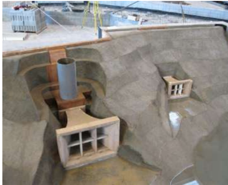
Նկ. 12 Հիդրոկուտակիչ էլեկտրակայանի ջրընդունիչ հանգույցի (Պորտուգալիա) մոդելավորման օրինակ Մ 1:33
